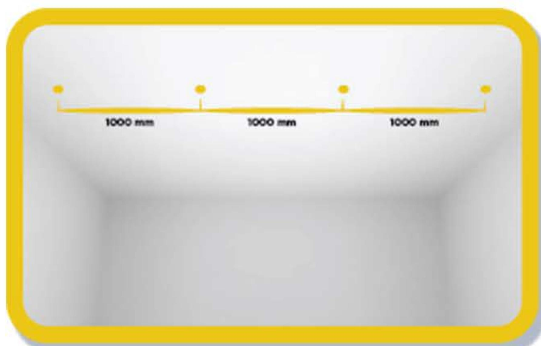
Buat lubang untuk pemasangan tiang hanger (WPC Keel). Jarak antar titik pemasangan 1000mm.
