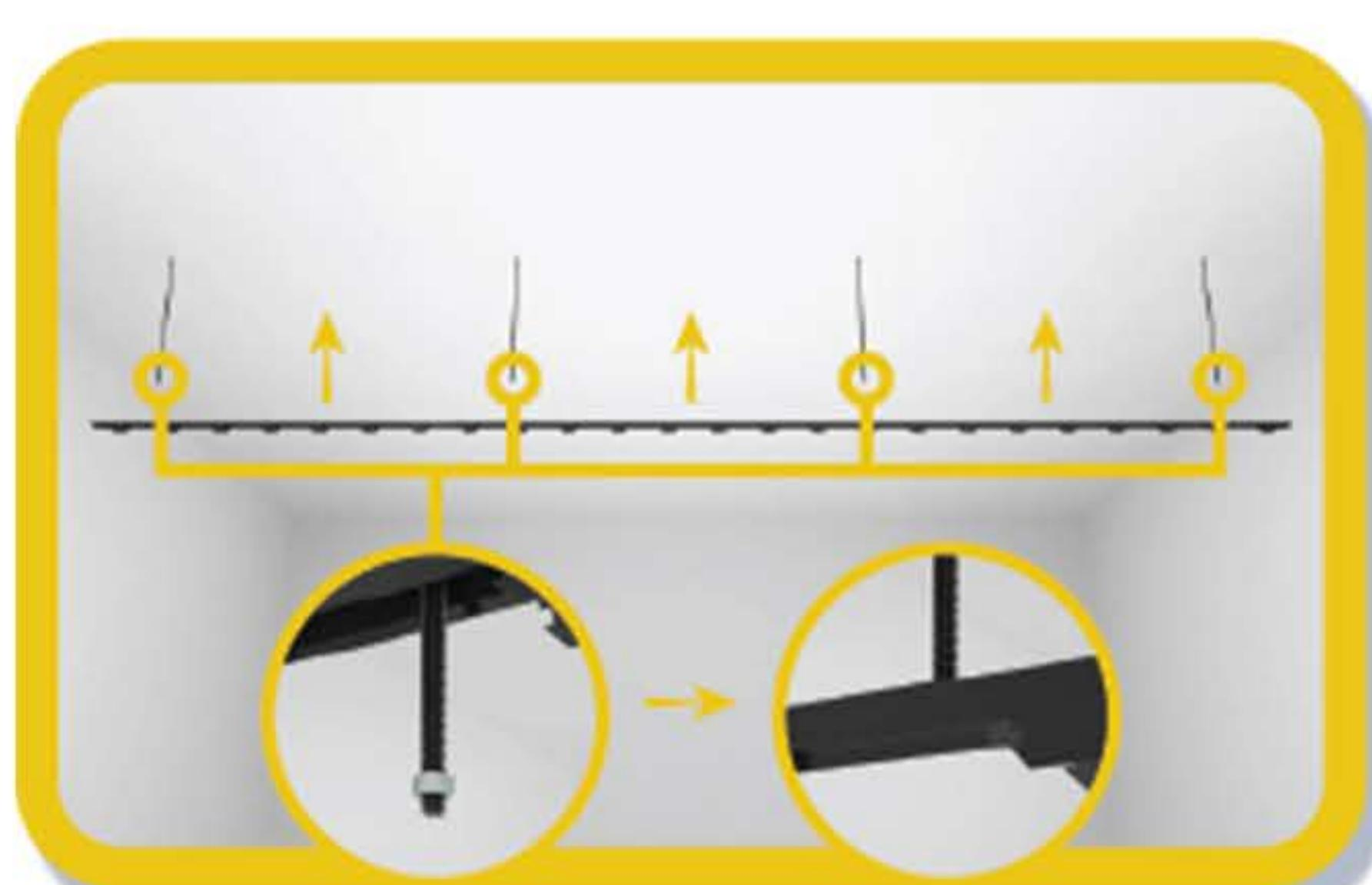
Pasang joist ke dalam tiang hanger lalu pasang securing nut pada tiang hanger sebagai penahan joist.
